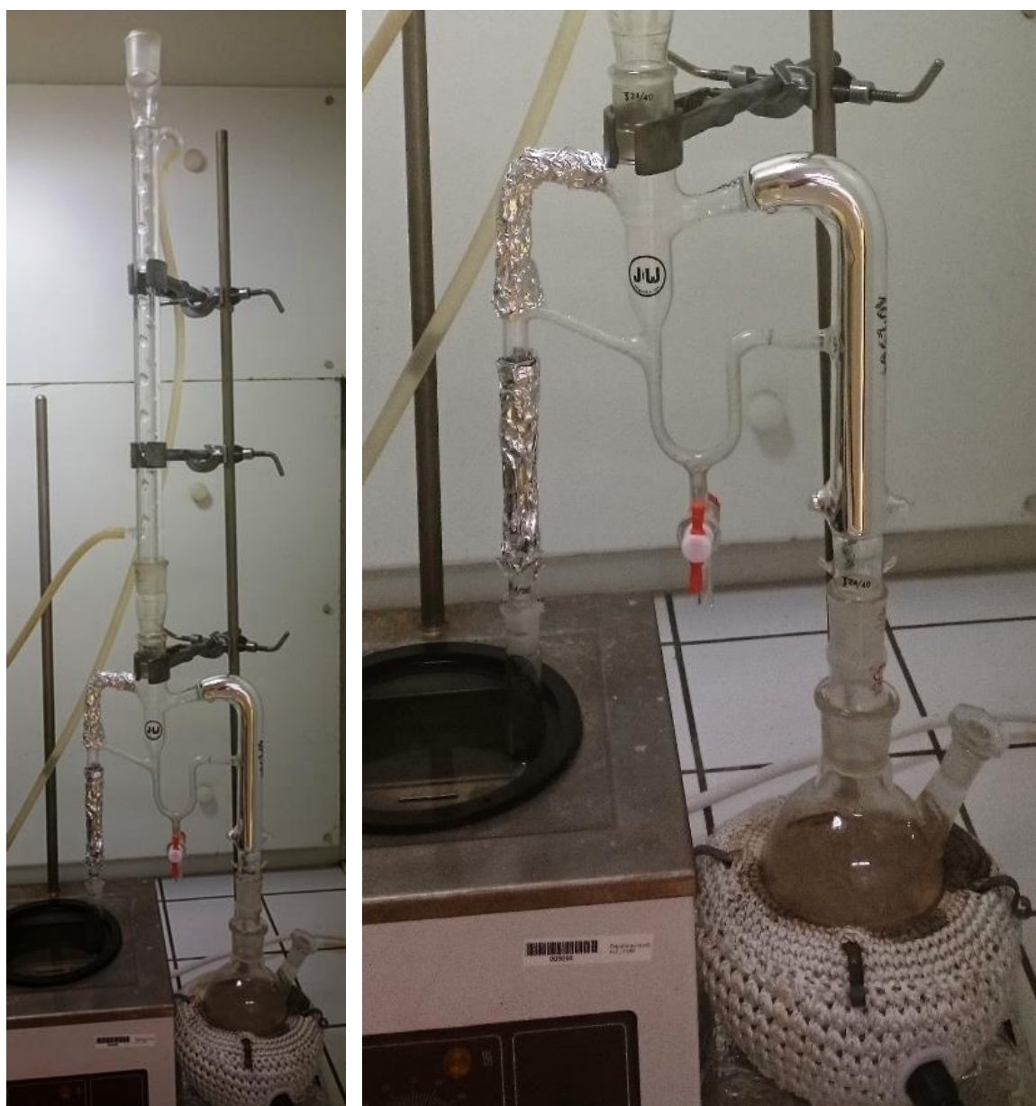
Obrázek 4 - Fotografie aparatury použité pro destilační extrakci
