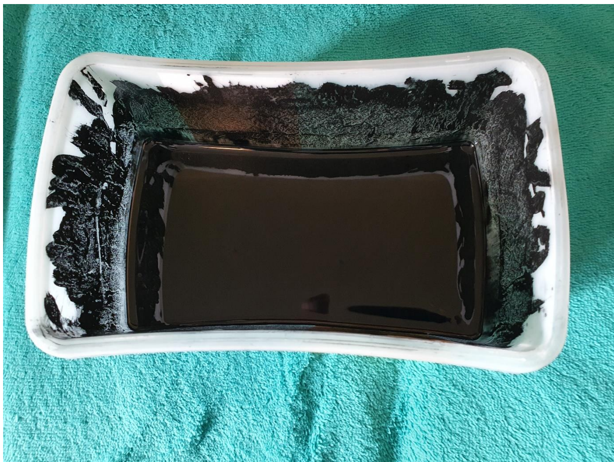
Obrázek 4: Stopovací inkoust z rostlinného oleje a práškového uhlí. Fotografie: Tomáš Poříška.
