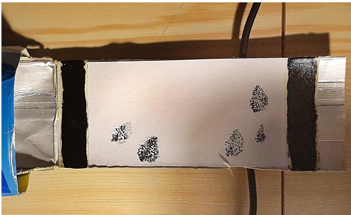
Obrázek 3: Vložka opatřená platformou a inkoustem. Vzory na platformě jsou pouze testovací a byly vytvořeny pomocí houby na mytí nádobí. Fotografie: Tomáš Poříška.
