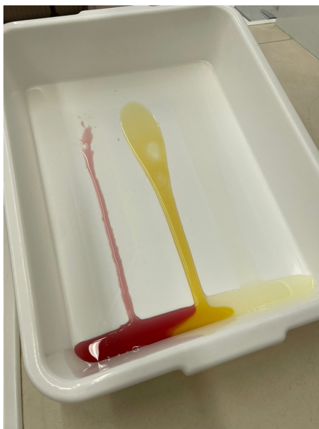
Obr. 14: Nakloněná rovina se vzorky – z leva doprava: sirup, med, olej (vlastní zpracování)
