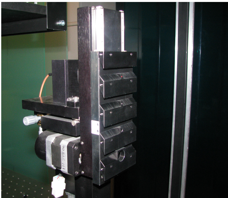
Obr. 22 – Detail měřící hlavy s detektorem a clonami.
