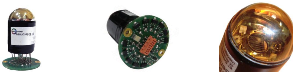
Obr. 12 Použitý fotonásobič 9114FLB. (ET Enterprises)
