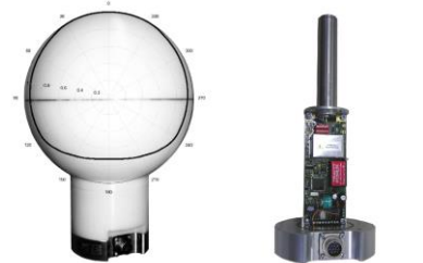
Směrová závislost neutronové sondy MDN-01 pro zdroj 252 Cf. Na obrázku vpravo bez Barnerovy modernizace kódu.
