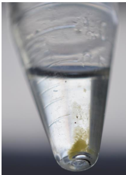
Obrázek 13: Vzorek apocytochromu s DTT a GuHCl po centrifugaci. Je viditelný žlutozelený precipitát.
