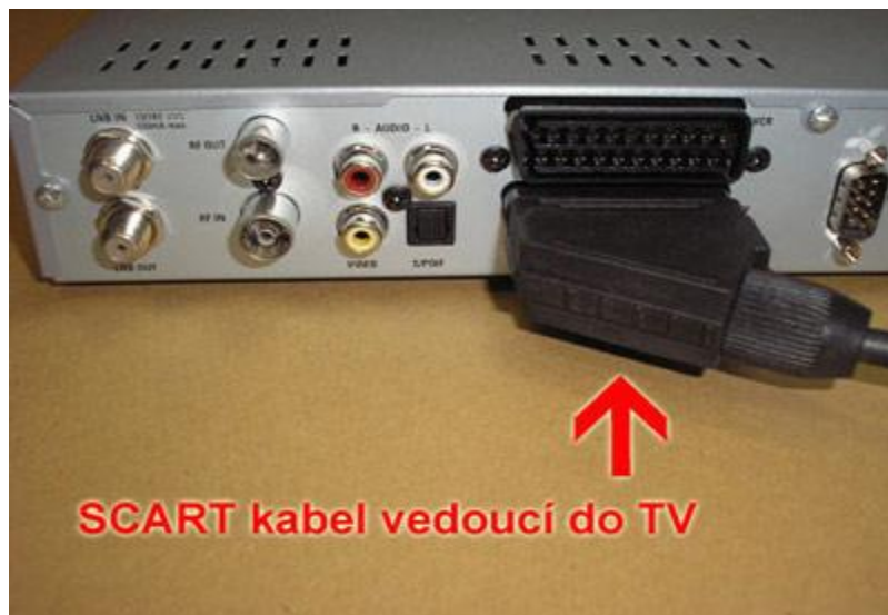
Obr. 13 Připojení satelitního přijímače kabelem typu scart – scart (24)
