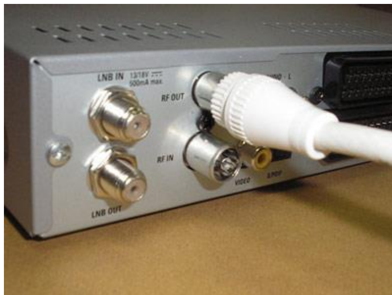
Obr. 13 Zapojení satelitního přijímače přes anténní vstup (22)
