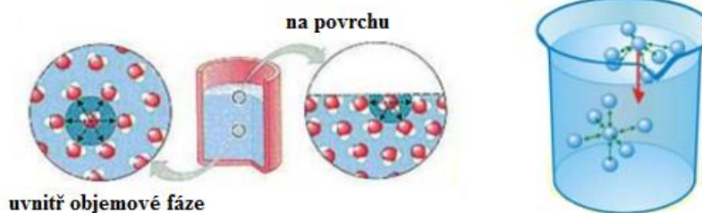
Obr. 6 Znáznornění mezimolekulových interakcí pro molekuly, které se nacházejí uvnitř objemové fáze a naopak molekuly, které jsou na rovině povrchu [15].
