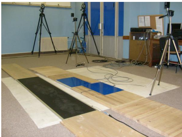
Obrázek 24. Pohled na použité silové plošiny
