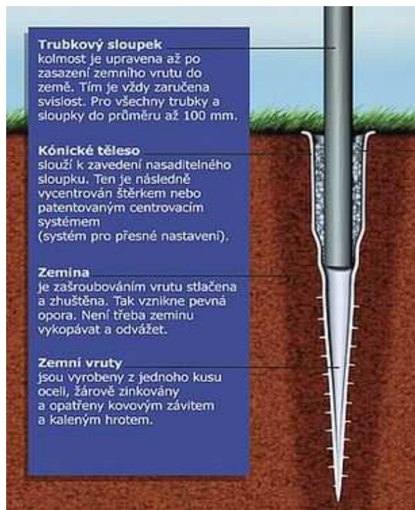
Obrázek č. 1: Detail hlubinných základů zhotovených ze zemních vrutů s popisem. Převzato a upraveno. (KRINNER CZ, 2008)
