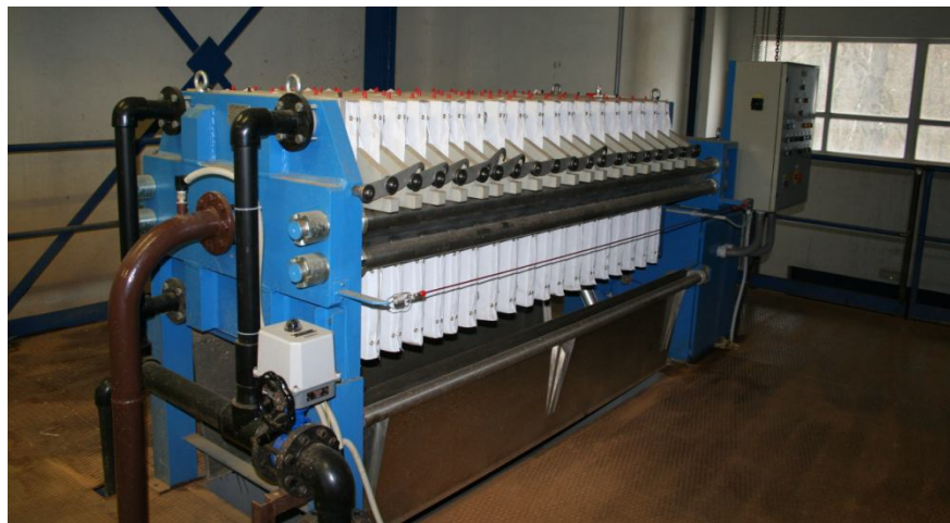
Obrázek 5: Filtrační lis (kalolis). Foto Ivo Medřík 14. 6. 2004
