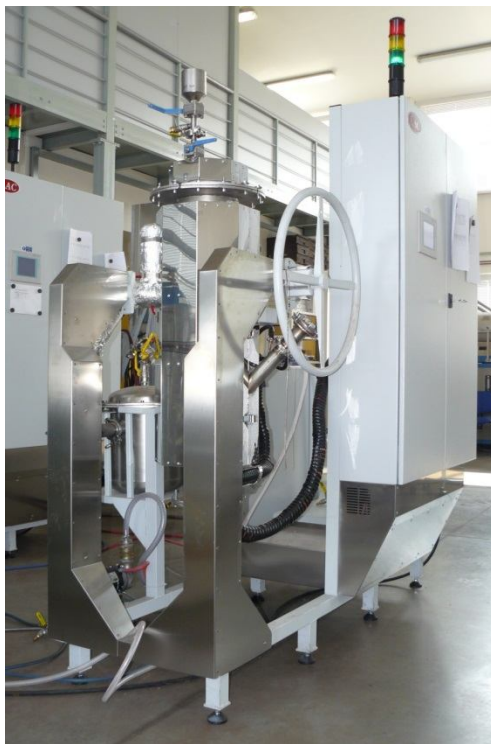
Obrázek 8: Laboratorní fluidní pec RPL využívaná pro redukci kalů na nanokompozitní materiál. Foto Ivo Medřík 15. 3. 2010
