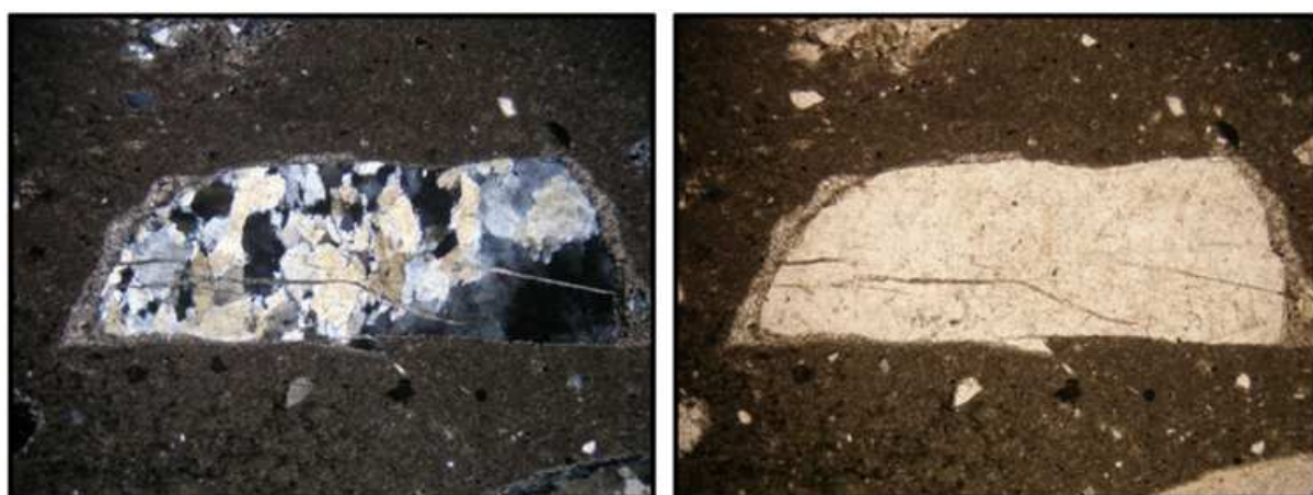
Obr. 26: Samostatný poloostrohranný klast kvarcitu (3 mm x 1,5 mm) v karbonátové matrix, nalevo v XPL, napravo v PPL, výbrus č. 2
