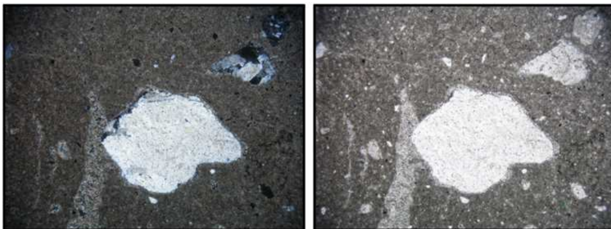
Obr. 16: Poloostrohranný klast křemene (0,25 mm x 0,3 mm), uvnitř karbonátové matrix, nalevo v XPL, napravo v PPL, výbrus č. 11
