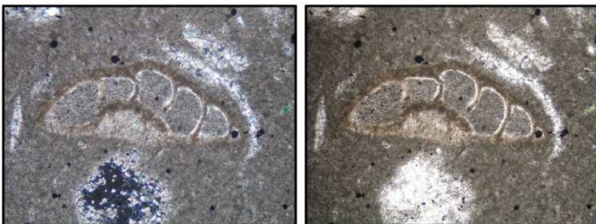
Obr. 30: Velká spirální foraminifera (0,75 mm x 0,25 mm), nalevo v XPL, napravo v PPL, výbrus č. 2
