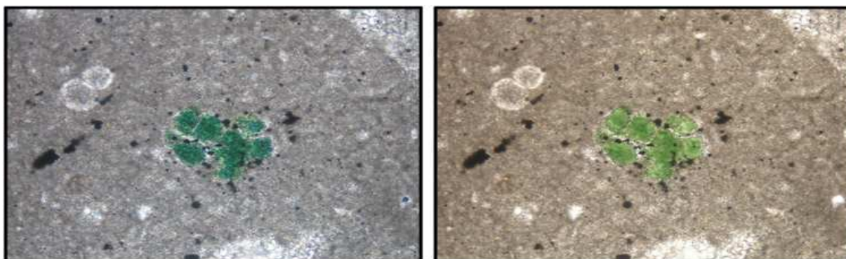
Obr. 18: Nepravidelný agregát glaukonitu (0,25 mm x 0,3 mm) tvořený shlukem šupinek, kolem kterých jsou opakní minerály (některé jsou i uvnitř glaukonitu), nalevo v XPL, napravo v PPL, výbrus č. 3
