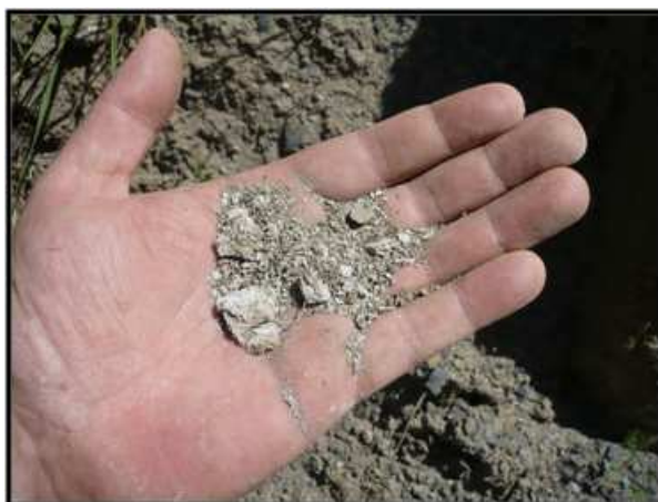
Obr. 12: Jíl vyplňující pukliny v polohách drob a slepenců
