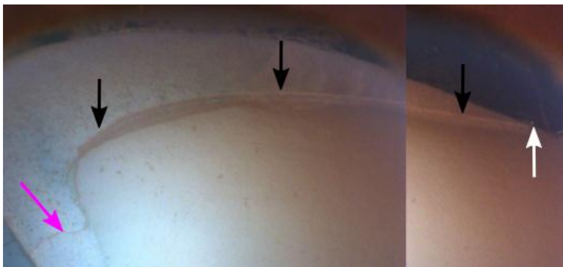
Obrázek 25 Fotografie části vzorku č. 9 pořízená CCD kamerou laserové ablace. Růžovou šipkou je označena prasklina ve sklovině zasahující až do ablatované linie označené černými šipkami. Bílá šipka naznačuje přiblížení ablatované linie k povrchu skloviny.
