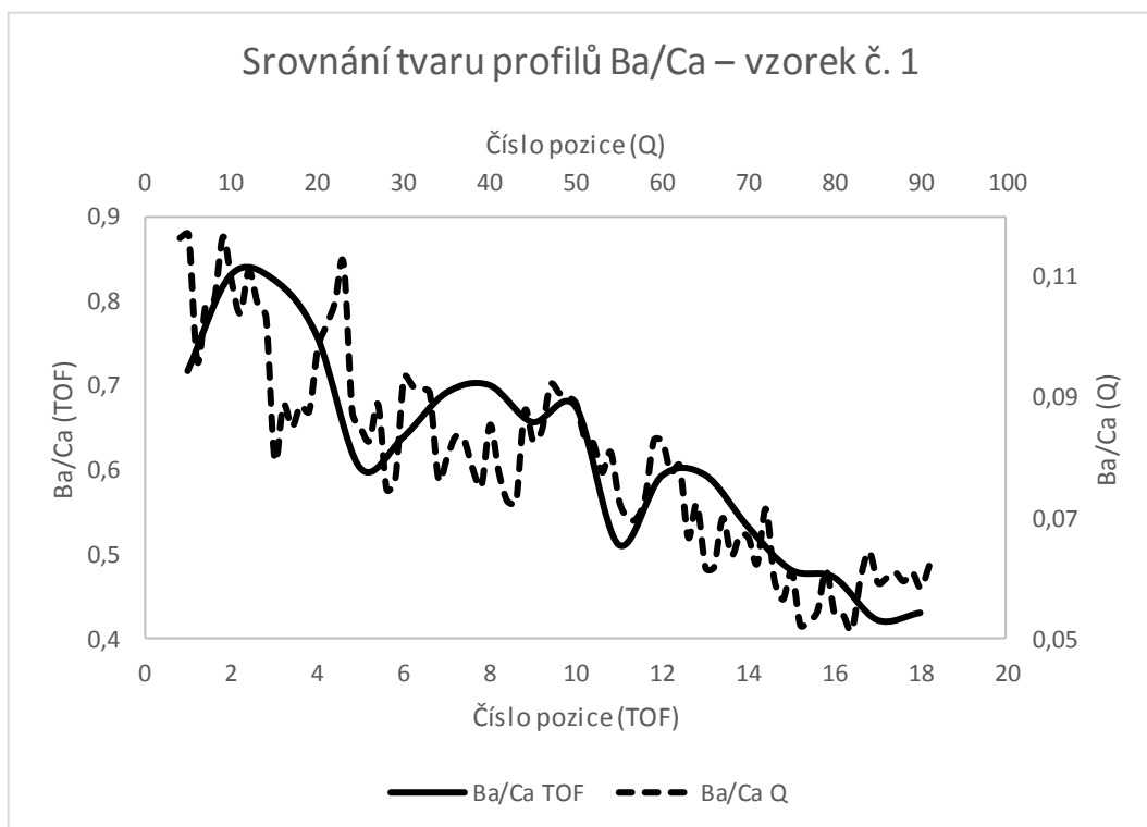
Graf 19 Srovnání tvaru profilů poměru ^{138}\text{Ba}/^{43}\text{Ca} získaných analýzou linie vedené v sekci „A“ vzorku č. 1 pomocí ICP-TOF-MS a ICP-Q-MS
