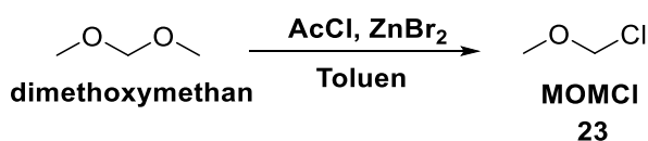
Schéma 13 Příprava MOM-Cl z dimethoxymethanu
