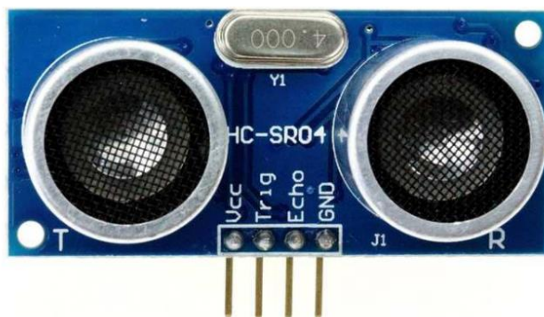
Obr. 9: Ultrazvukový snímač vzdálenosti HC-SR04 (Zdroj: https://johnny-five.io/img/components/hcsr04.jpg )
