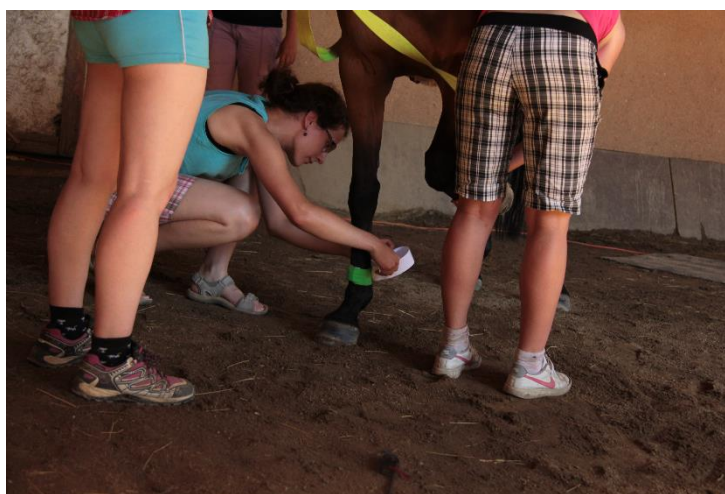
Obrázek 5. Připevnění akcelerometru nad spěnkový kloub koně (Autor: Kateřina Šušlíková, Ryzáček, z. s.).
