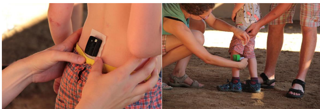
Obrázek 4. Připevnění akcelerometru v oblasti obratle L5 a senzoru EMG do oblasti m. triceps surae (Autor: Kateřina Šušlíková, Ryzáček, z. s.).
