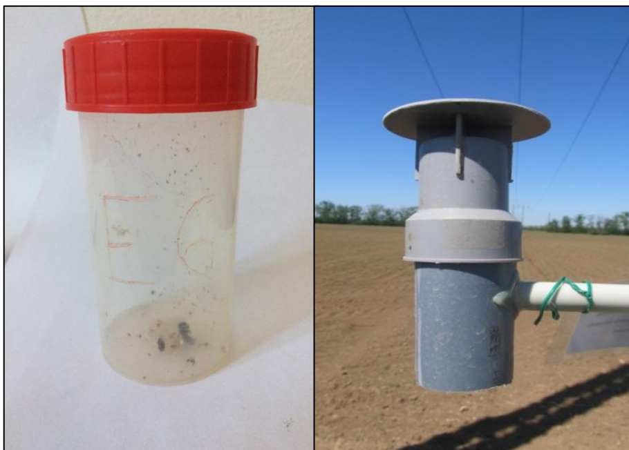
Obrázek 11 Zachycovací nádoba a její upevnění na deflametru (Diblíková 2018)
