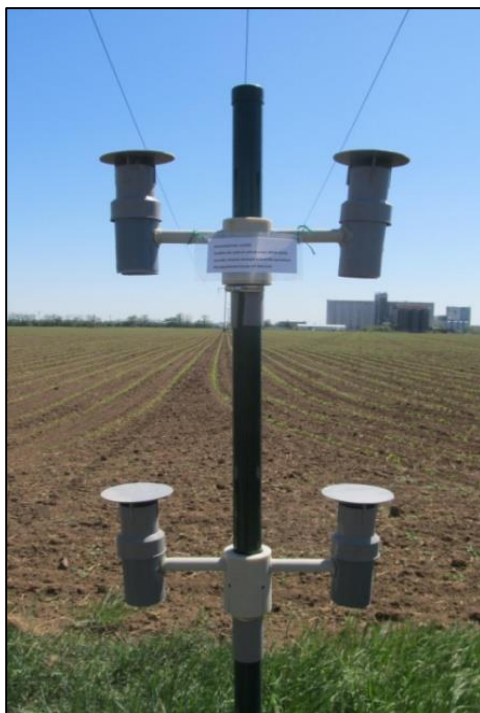
Obrázek 12 Upevnění nádoby k sloupku (Diblíková 2018)
