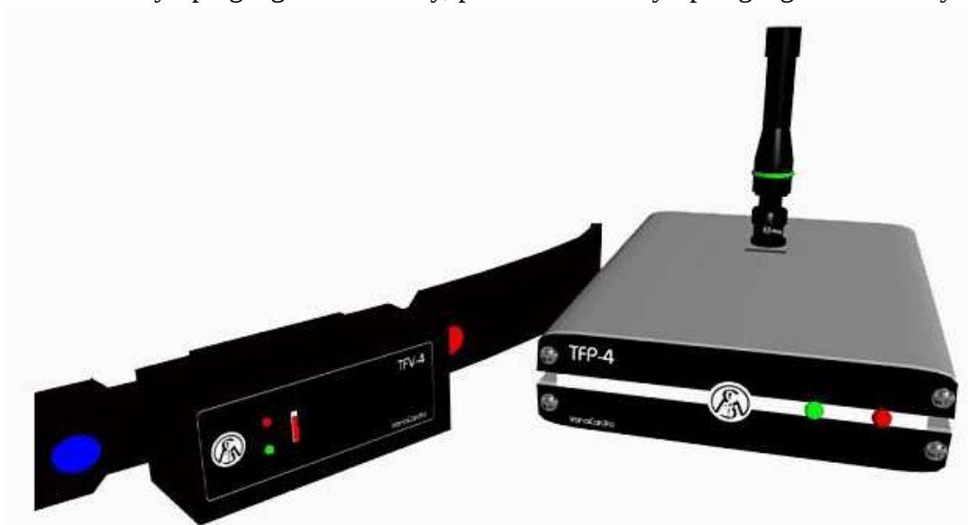
Obr. 4: Mikropočítačový systém VariaCardio TF4 (UHF přijímač a UHF vysílač) (Salinger et al. 1999)
