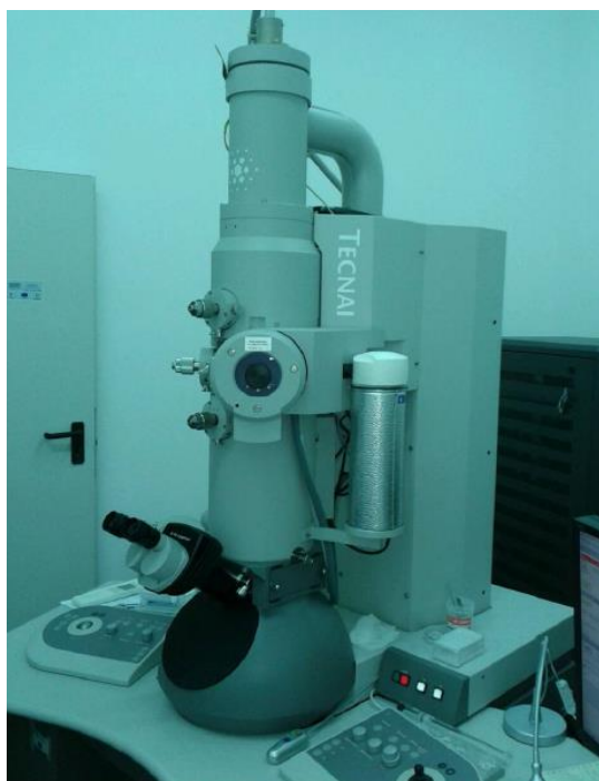
Obr. 3.3: Transmisní elektronový mikroskop FEI Tecnai.
