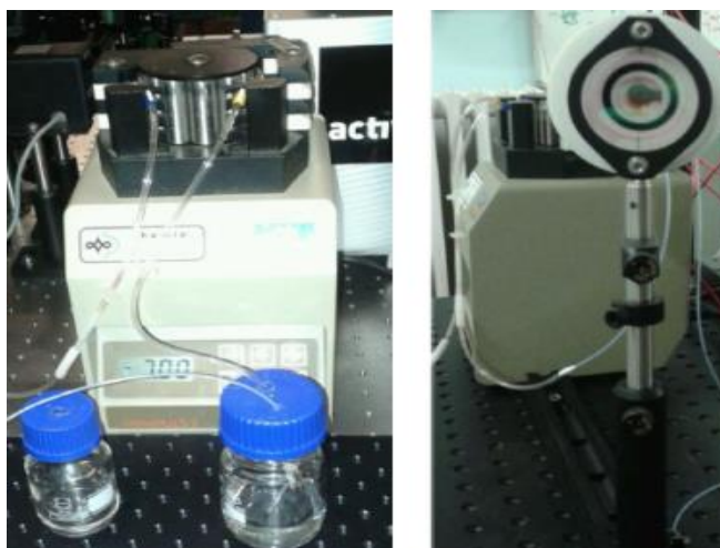
Obr. 3.2: Peristaltická pumpa Gilson Minipuls 3 se vstupní a výstupní hadičkou, které ústí do nádoby s 0,1% vodným roztokem kyseliny octové s biopolymerem chitosanem o koncentraci 1 \text{ g.L}^{-1} (vlevo). Průtoková cela propojena s peristaltickou pumpou (vpravo).
