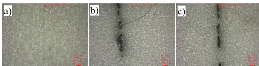
Obr. 4.41: Spáry na spodním povrchu hliníkové keramiky vytvořené pomocí QCW laseru s délkou pulsu 0,1 ms a parametry: a) 0,06 J, 12 přejezdů, b) 0,075 J, 6 přejezdů, c) 0,075 J, 12 přejezdů. Zvětšení 120x, červená škála 320 \mu\text{m} .
