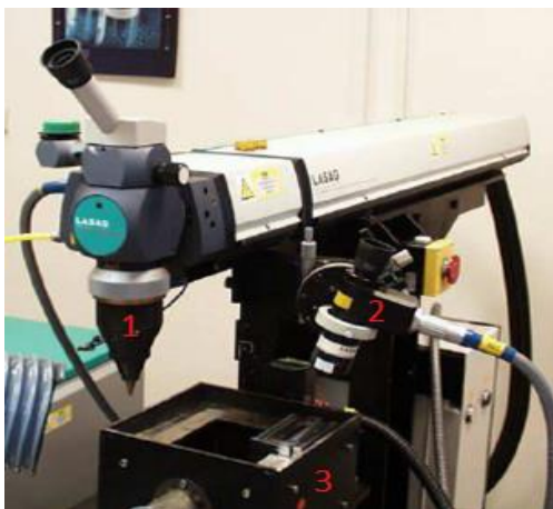
Obr. 3.3: Laserový systém LASAG KLS 246-102 (1- pevná pracovní hlava, 2- vláknová hlava, 3- posuvný pracovní stůl).
