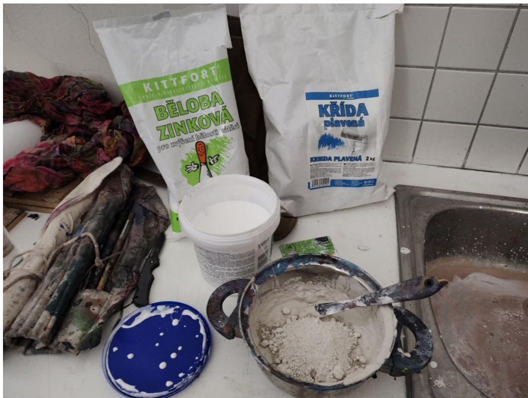
Obrázek 28 Výroba směsi z plavené křídý, pigmentu a disperze.
