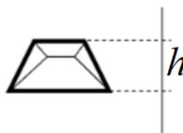
Obrázok č.17: Hrúbka implantátu h : 150, 200, 250, 300, 350 \mu\text{m} (upravené) [9]
