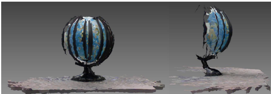
Obr. 31 Výsledek skenování školního globusu – Kinect One, KScan3D (zdroj: autor).
