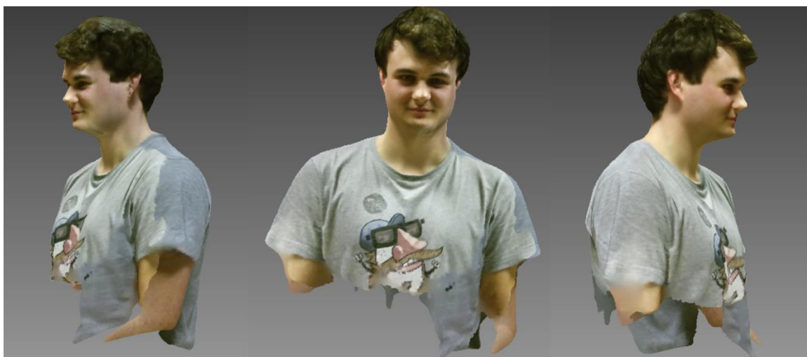
Obr. 35 3D model obličeje – Kinect One, KScan3D (zdroj: autor).
