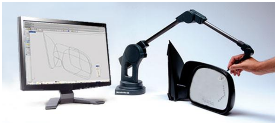
Obr. 2 Kontaktní skener MicroScribe (zdroj: http://www.picasoft.com/ ).
