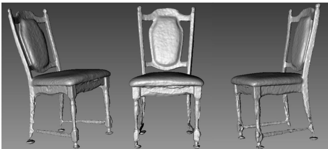
Obr. 41 3D model dřevěné židle – Asus Xtion, KScan3D (zdroj: autor).
