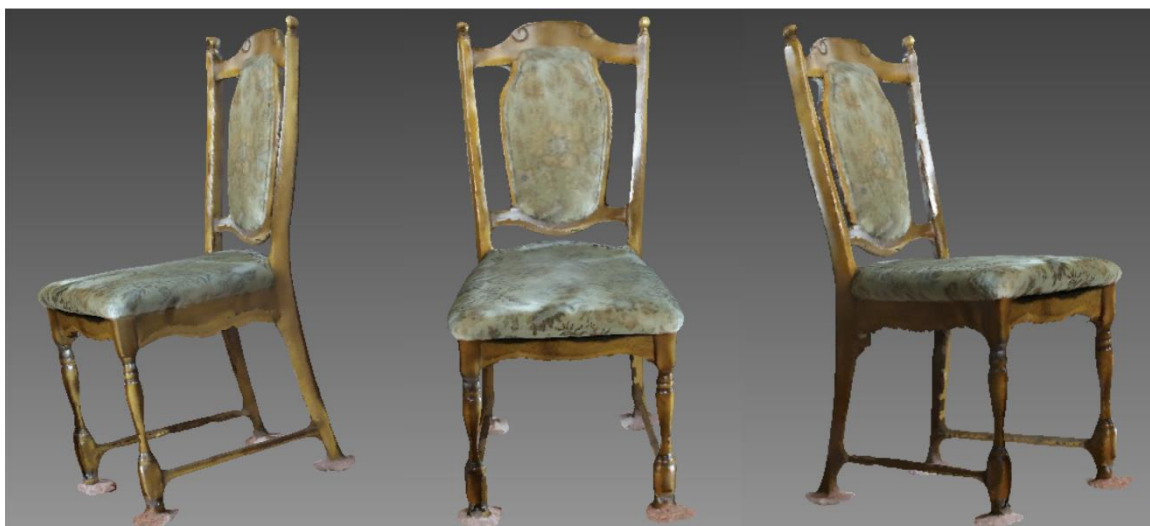
Obr. 40 3D model dřevěné židle – Kinect One, KScan3D (zdroj: autor).
