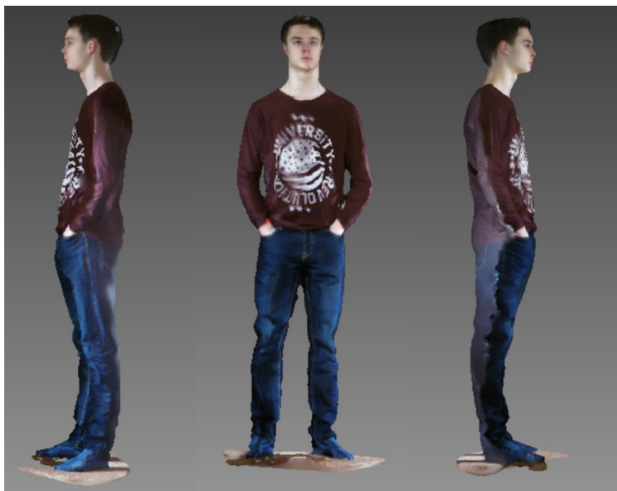
Obr. 44 3D model postavy člověka – Kinect One, KScan3D (zdroj: vlastní).
