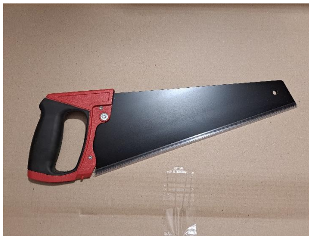
Obr.9 Pila ocaska (foto autor)
