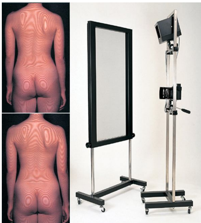
Obrázek 10. Ukázka zařízení a výstupu ze systému Rakuten (princip moiré)
