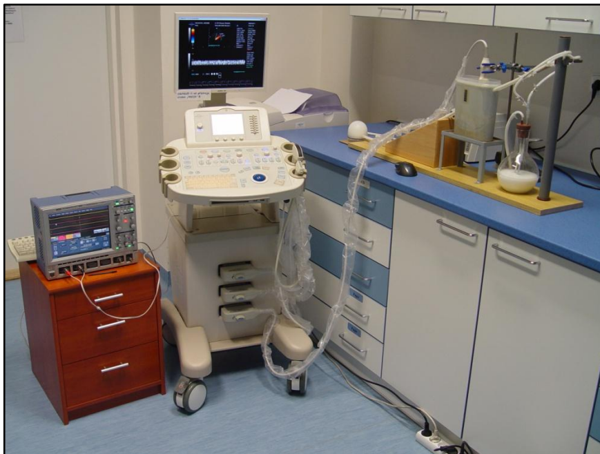
Obr. 2.5 Záznam akustického spektra osciloskopem LeCroy
