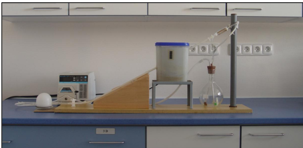
Obr. 2.1 Dopplerovský průtokový fantom
