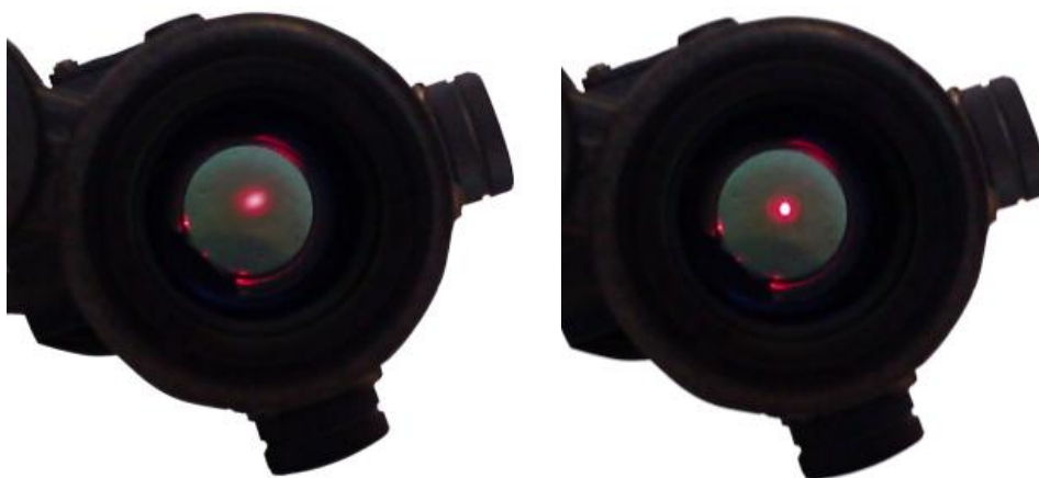
Obrázek 12: porovnání tvaru světelného bodu u střelce s nekorigovaným astigmatismem (vlevo), resp. po korekci (vpravo)
