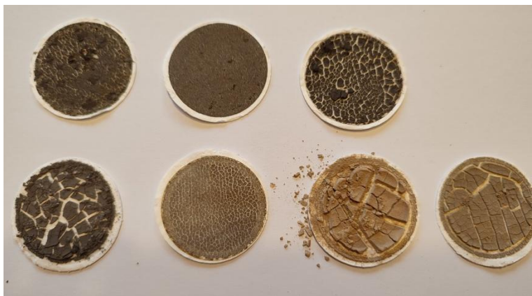
Příprava vzorku č. 2 na membránových filtrech metodou hustotní flotace s aerací
