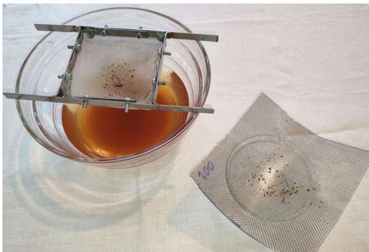
Příprava vzorků č. 1 na sítích 0,5 mm a 1 mm
