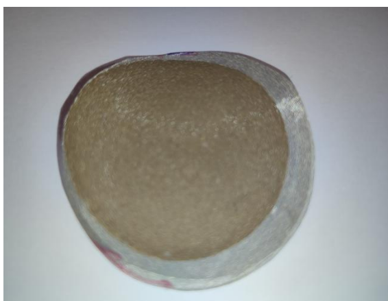
Příprava vzorků č. 1 na sítích 0,1 mm a 0,05 mm
