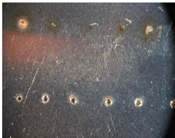
Obr. 30: Detailní srovnání otvorů pro vrtání na vzduchu (nahore) a s kapalinou (dole)
