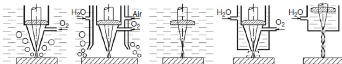
Obr. 12: Možné metody kontaktu obrobku s kapalinou při obrábění (převzato z [1])
