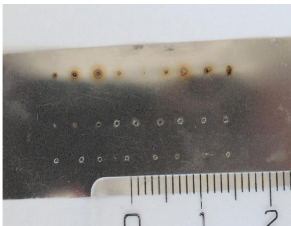
Obr. 29: Srovnání kvality otvorů pro vrtání na vzduchu (horní řádek) a s kapalinou (prostřední a spodní řádek)
