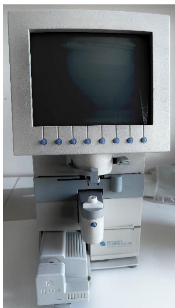
Obrázok č. 6: Spektrometer, prístroj na meranie spektrálnej priepustnosti optických prvkov.
